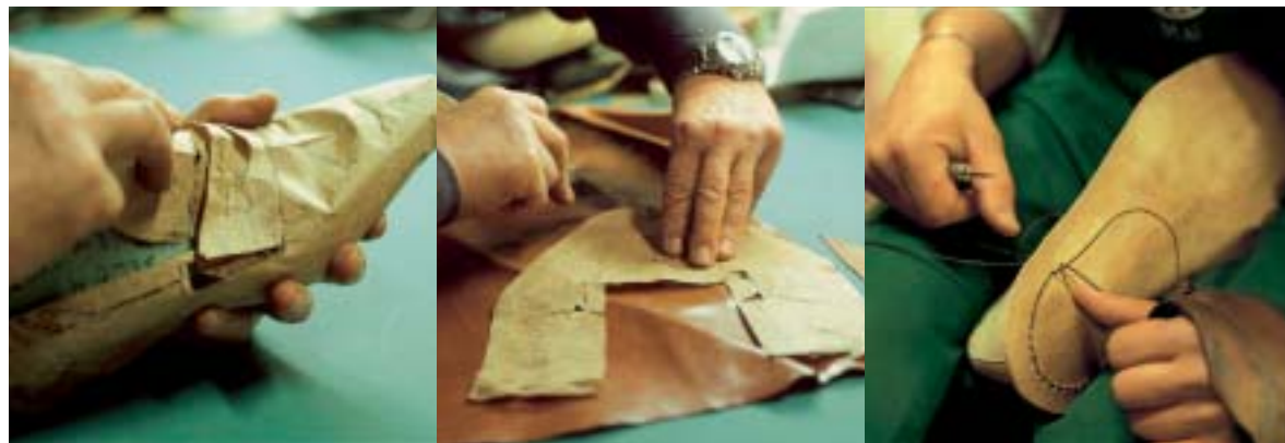
Handwerkskunst: Hartplastik-Leiste gießen, Schnittmuster anfertigen, Schaft und Brandsohle zusammenheften
